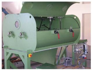
Fig. 3: Beleimmischer, Pilotanlage des Leibniz-Instituts für Agrartechnik Potsdam-Bornim e. V. (ATB)
